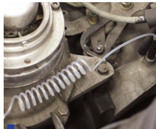
Podczas czyszczenia układu dolotowego preparat podawany jest bezpośrednio do kolektora.
